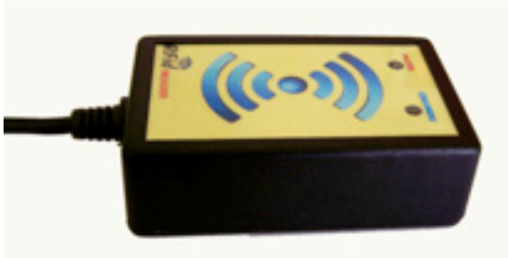
Şekil 5: Personel Devam Kontrol Sistemi RFID Kart Okuyucu
