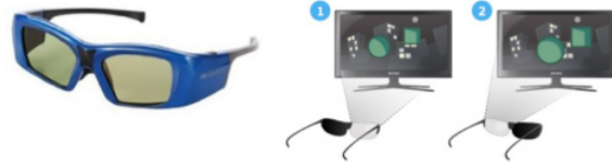
Şekil3. Aktif Shutter 3B gözlük ve zaman sıralı görüntüleme yöntemi
