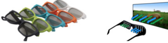
Şekil2. Pasif polarizasyon 3B gözlük ve görüntüleme yöntemi
