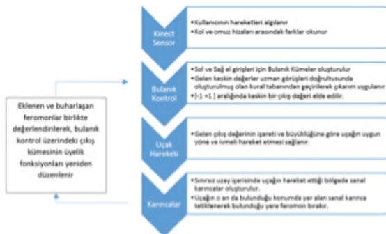
Şekil 11 Dinamik fonksiyonlu bulanık kontrol mekanizması akış diyagramı
