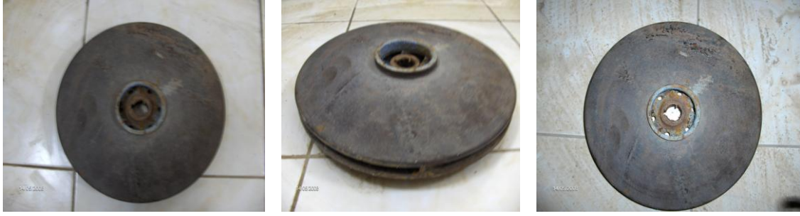
Şekil 10. Çarkın 180 saatlik dönem sonundaki genel görünümü
