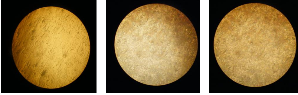
Şekil 9. Dökme demir malzemenin metalografi mikroskobunda çekilen mikroyapı görüntüleri
