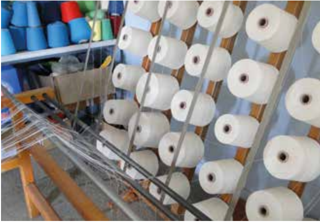
Fotoğraf 11- Çağlık üzerine yerleştirilmiş masuralar / Bobbins on the warping creel (Fotoğraf için kaynak kişi / Source for photo: Arzu ARSLAN ) (Yıl/Year: 2016)
