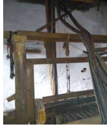
Fotoğraf 14 - Eski Tamzara bezi dokuma tezgâhında çözgü ipinin tezgâha çekilmiş hali / Warp thread drawn into loom on old Tamzara linen weaving loom (Fotoğraf için kaynak kişi / Source for photo: Mine CERANOĞLU) (Yıl /Year: 2013)
