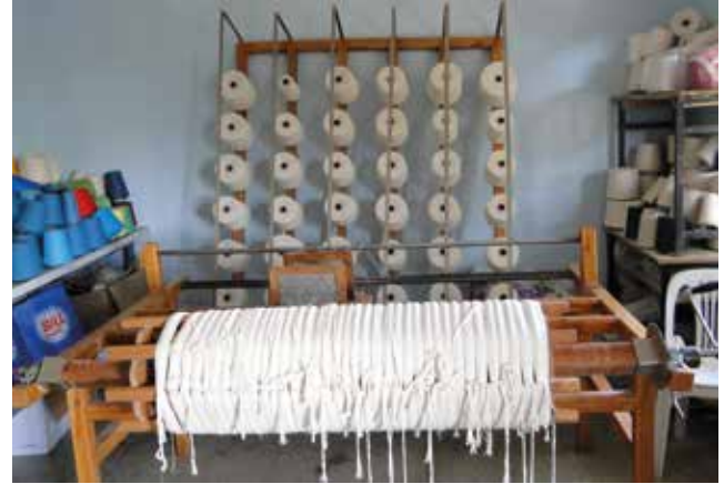
Fotoğraf 13 - Günümüzde hazırlanmış ve dolaba sarılmış çözüğü ipliği / Warp threads prepared and wrapped on frame today (Tamzara Bezi Dokuma Atölyesi) (Fotoğraf için kaynak kişi / Source for photo: Arzu ARSLAN ) (Yıl/Year: 2016)
