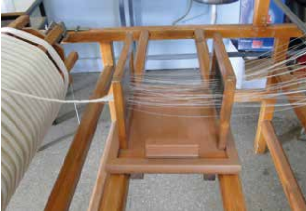
Fotoğraf 13 - Günümüzde hazırlanmış ve dolaba sarılmış çözüğü ipliği / Warp threads prepared and wrapped on frame today (Tamzara Bezi Dokuma Atölyesi) (Fotoğraf için kaynak kişi / Source for photo: Arzu ARSLAN ) (Yıl/Year: 2016)
