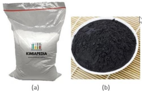
Şekil 17. KOS işleminde kullanılan toz malzemeler: a) baryum karbonat; b) bambu kömürü (Darmo v.d., 2021).
