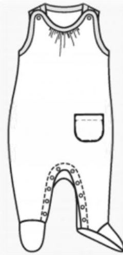
Şekil 3. Omuzdan çitçitli kolsuz bir patikli tulumu ait teknik çizim (Mueller&Sohn, 2021) Figure 3. Technical drawing of a sleeveless bootie jumpsuit with snap fasteners on the shoulders
