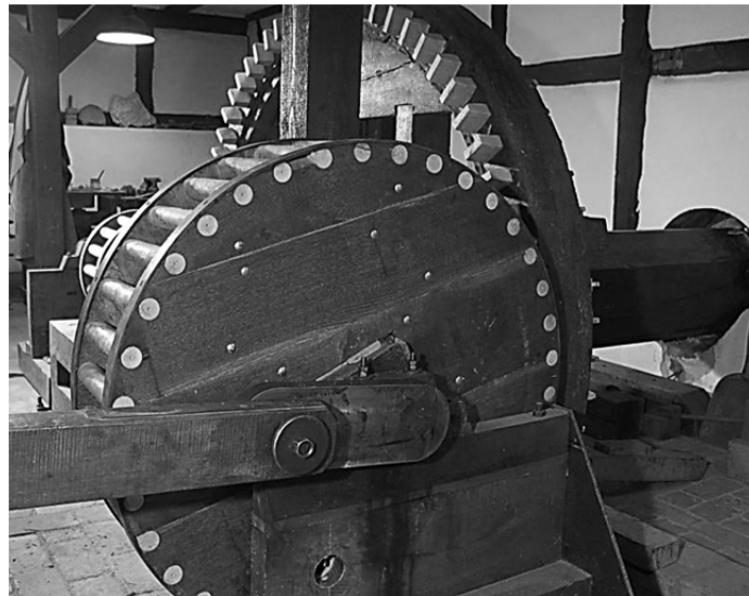
Abb. 6: Die Kraftübertragung vom Zahnrad über Drehling und Schubstange auf den Sägeschlitten entspricht beim Schweriner Modell im Wesentlichen der Darstellung auf dem Ammianos-Relief.
