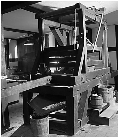
Abb. 5: Alte „Schleifmühle“ in Schwerin. Nach historischen Vorbildern nachgebaute Steinsäge.
