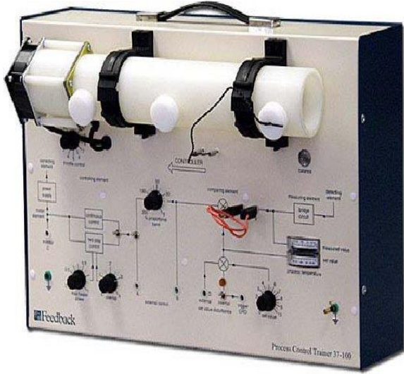
Şekil 18. Hava ısıtma deney seti görünümü
