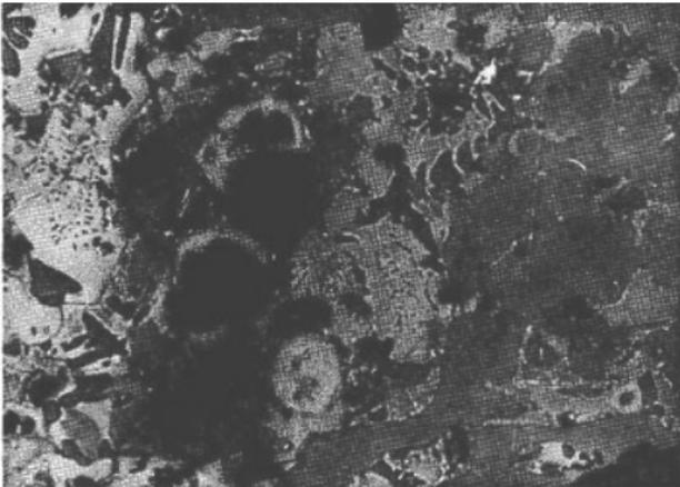
Abb. 19 - Madenbelenitepe: TG153 B-1.2, Bleistein (Chalkosin, dunkelgrau und Magnetkies, hellgrau und Magnetit, mittelgrau), Speis (Arsenoferrit, hellgrau und Magnetkies) und Bleikügelchen (metall. Blei, schwarz und metall. Eisen, weiß) in der Schlacke, Bildbreite 0,690 mm.
